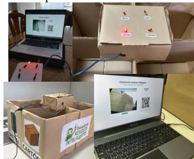
Fig. 8. Prototipo de la estación de residuos inteligente desarrollado.
