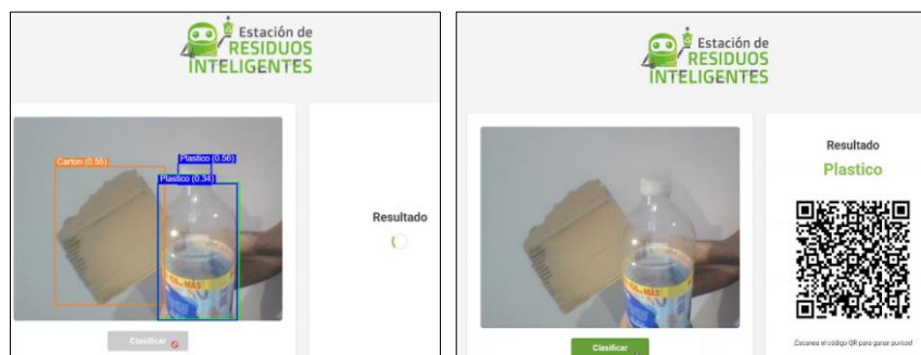
Fig. 7. Detección de imágenes usando YOLO (Izquierda) y Resultado de la clasificación junto con un código QR en la aplicación web (Derecha)
